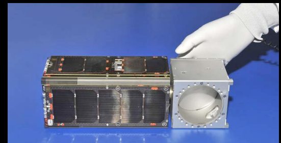
MicroMAS 3U CubeSat (MIT LL / MIT) [30]
